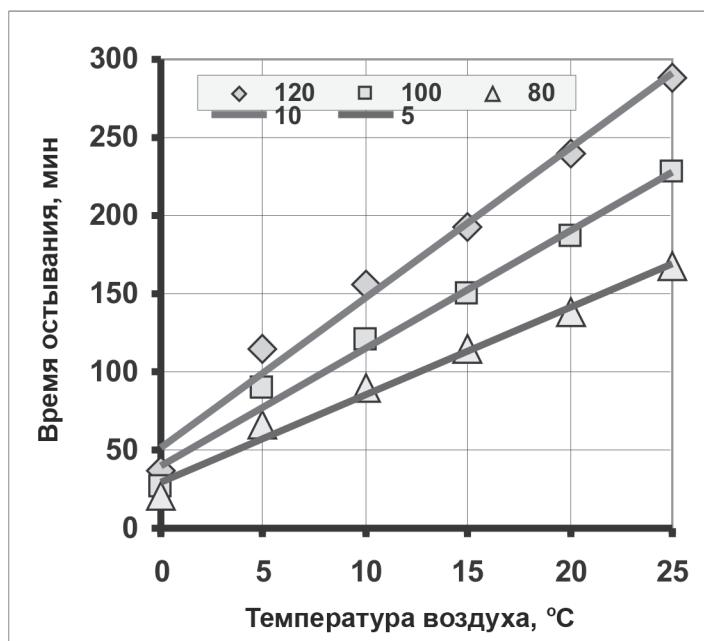
Рисунок B.2 – Время остыния холодной асфальтобетонной смеси до температуры 25 °C
